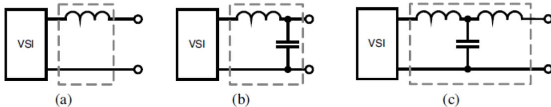
Fig.1: Filter Topologies (a) L-Filter (b) L-C Filter (d) L-C-L Filter [8]
